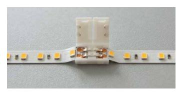
3. LED-Tape in die vorhandene Einschubhilfe beim Clip einführen. Tape unterhalb der vorhandenen Kontakte einschieben. Plus-/Minus-Polung beachten!
