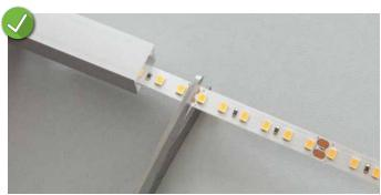
2. Tape immer rechts oder links direkt an der LED trennen.
