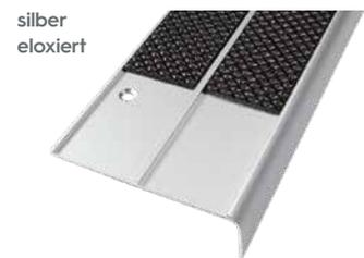
Die Antirutscheinlage wird lose mitgeliefert. Die Treppenprofile sind zur Befestigung vorgebohrt. Nach Montage (Verschraubung) der Profile wird die Einlage eingeklebt.
